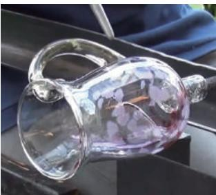
グラスの形ができたら取っ手になる柔らかいガラスを下から上にのばしてつけて「たね切りバサミ」で切って、取っ手の形に仕上げます。
