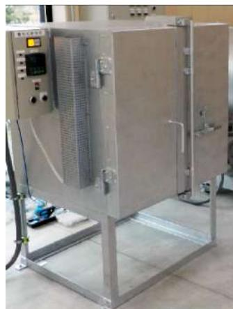
吹きガラスの作業は、約1200°C～600°C位で作業をします。急に室温まで戻すとガラスは割れてしまいます。よって、吹きガラスで作ったガラスは全て、徐冷炉に入れます。工房の作業中の徐冷炉の温度は約500°Cです。工房の全ての作業が終了したら一晩かけて室温まで下げていきます。
