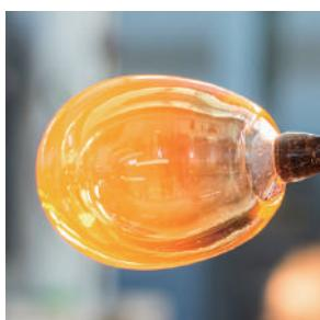
下玉を冷ました後にもう一度、「溶解炉」の中に入れて2層目を重ね巻きします。
