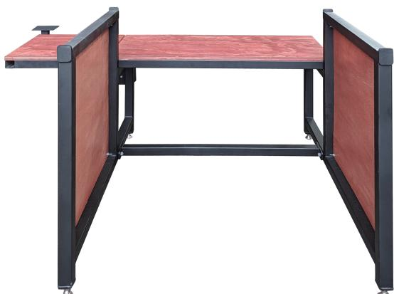
吹きガラスの作業はベンチに座って成形します。右端に座り、吹き竿を前にかけて、右手で道具を持って作業を行っていきます。
