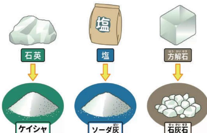
普通のガラスは、珪砂（ケイシャ）・ソーダ灰・石灰が主な原料で、さらに丈夫にするためや色をつけるために必要な原料を加え、よく混ぜて、高い温度でガラスにします。
