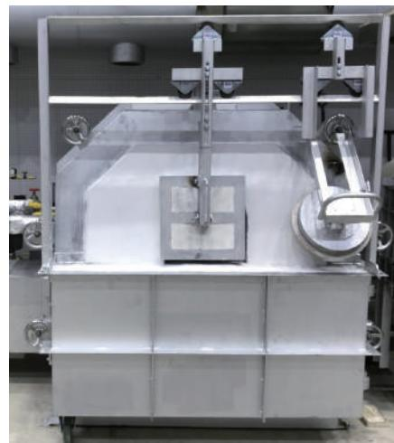
ガラス溶解炉は、1300°Cの高熱で約10時間かけてガラスの原材料を溶かしています。吹きガラスの作業をする温度は約1200°Cです。ガラス溶解炉には約100kgのガラスが溶けています。
