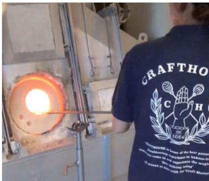
「溶解炉」の中で約1200℃で溶けているガラスをステンレス製の「吹き竿」の先に巻き取ります。
